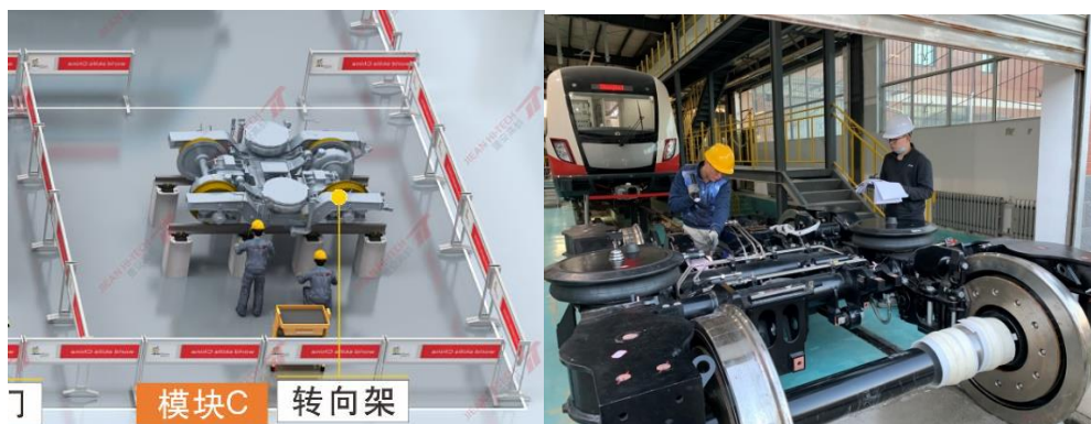
图 14 转向架检修实训区
