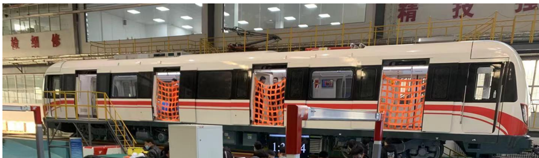
图 15 整车检修平台
