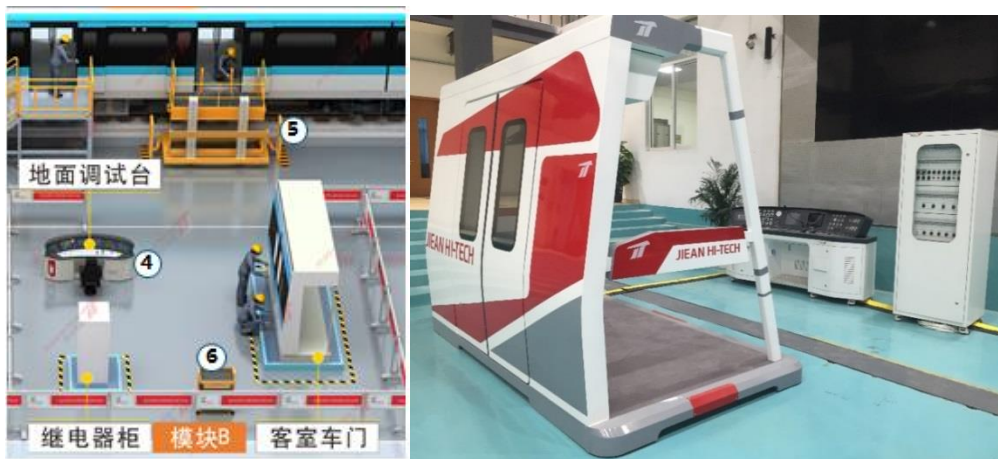
图 13 客室车门检修实训区
