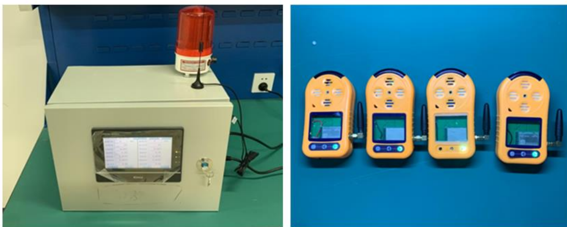
图 6 救援联动式桩基井有害气体检测仪
